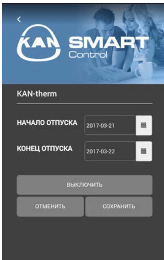
Чтобы установить программу „отпуск”, определяем начало и конец отпуска, а затем нажимаем опцию „сохранить”. В окне помещений, приписанных к клеммной колодке, для которой активирована программа „отпуск” появится символ чемодана, который информирует нас, что активирована программа „отпуск”.
