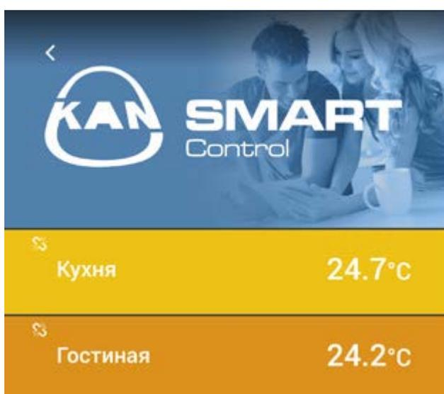
При выборе опции „настройки помещения” отображается список помещений (термостатов), подключенных к клеммной колодке. Выбираем помещение, в котором мы хотим изменить параметры
